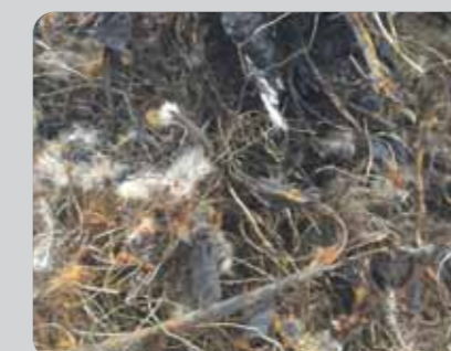
Ferro da impianto trattamento PFU
